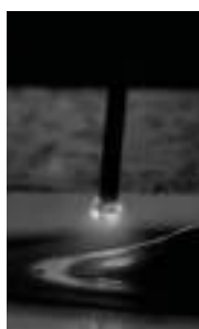
Reinigung und Vorwärmung des Drahtes in der negativen Phase
